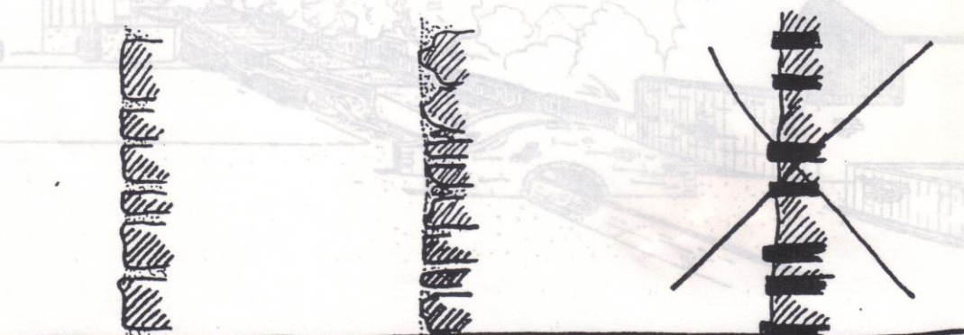
Joints en creux à la chaux et brossés
